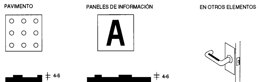
Figura 12.- Señalización táctil. Cotas en mm
